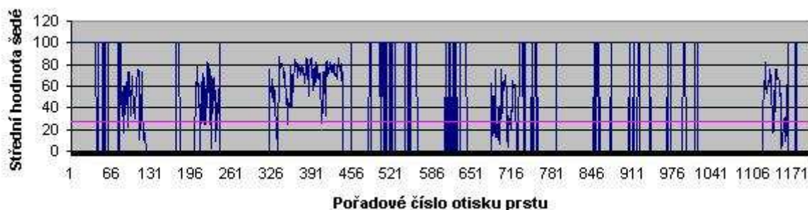
Obrázek 4: Střední hodnoty šedé pro senzor Suprema SFM3020 (průměr \cong 28)
