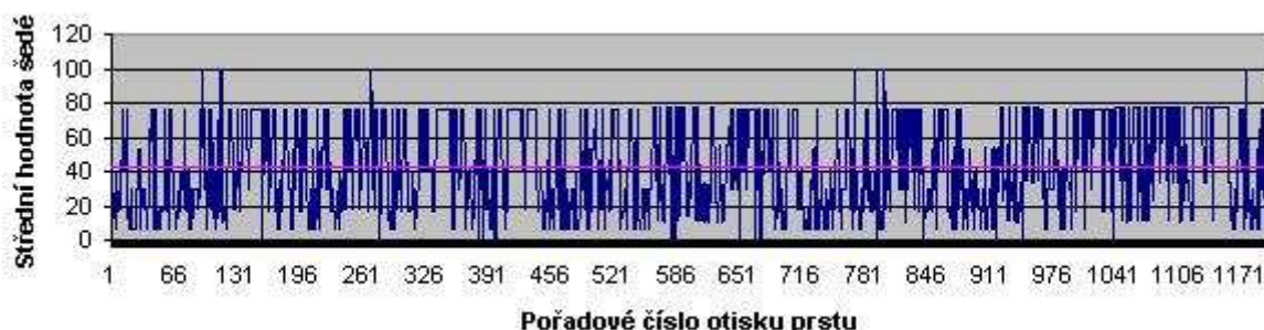
Obrázek 2: Střední hodnoty šedé pro senzor Suprema SFM3000 (průměr \cong 43)
